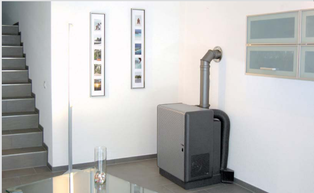
Standmodell mit Bodenluftaustritt «rechts» in Wohnzimmer
